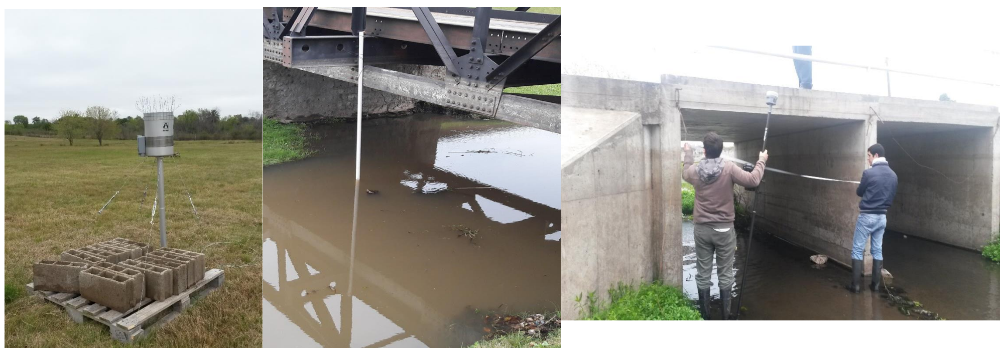
Pluviómetro y medidor de nivel colocados por el Departamento del Agua.
